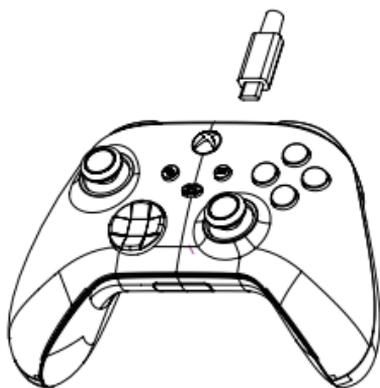
1. Dank der Akkus kann nun alternativ auch per USB-C Kabel (Xbox Series Controller) oder per Micro-USB Kabel (Xbone Controller) geladen werden
